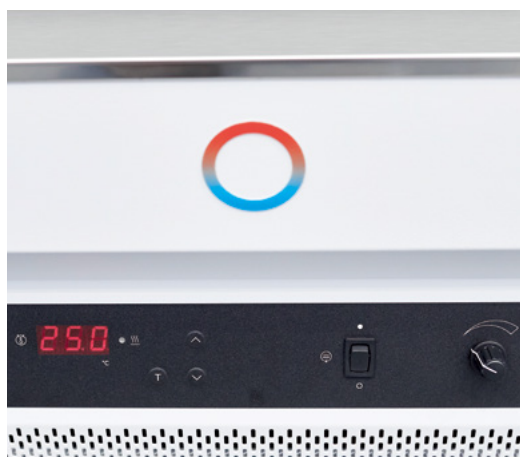
控制器左侧：带有LED显示的温度调节，右侧：振荡单元的速度调整
